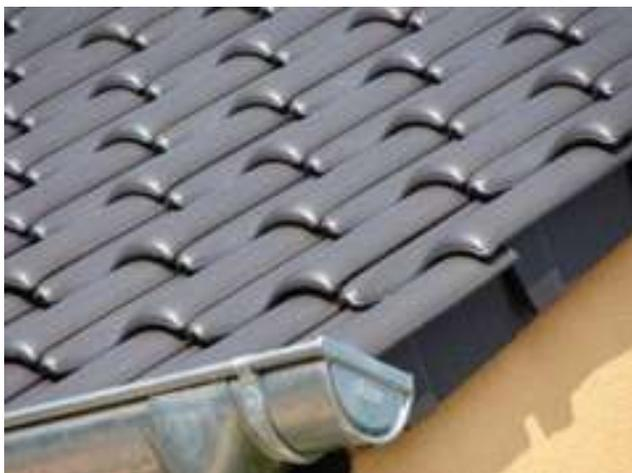
Cette tuile universelle polyvalente est particulièrement bien adaptée aux toits à faible pente à partir de dix degrés. La tuile E 58 SL est facile et rapide à mettre en œuvre et offre un format avantageux : 11,5 pièces au mètre carré.
